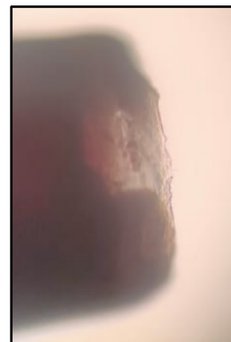
Gambar 3. Material Teflon IV Cath 20G Setelah dipakai
